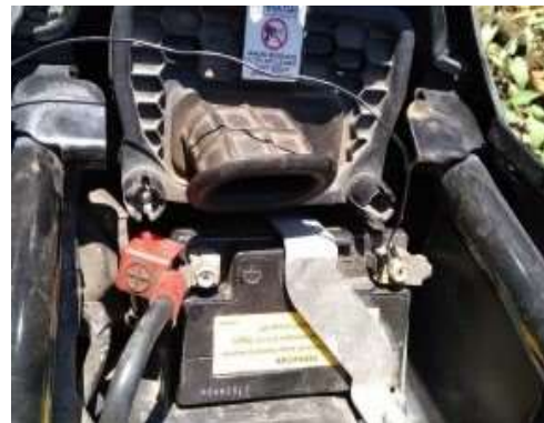
Gambar 10. Kabel daya dialirkan ke Aki
